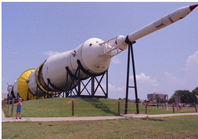
Bild 4 : Saturn V är den längsta och tyngsta raket som någonsin använts. Den användes vid alla Apollo-månlandningar, samt vid uppskjutningen av rymdstationen Skylab. Den är 111 m lång och 10 m i diameter. Detta exemplar finns att beskåda på Space Center Houston i Texas. Det mesta av tekniken i raketerna är tillämpad naturvetenskap.
